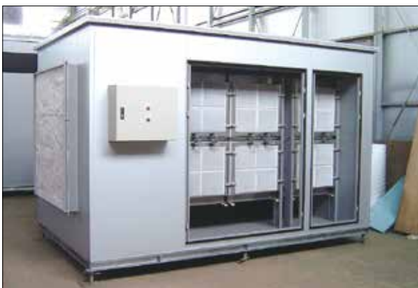
光触媒脱臭装置収容箱
